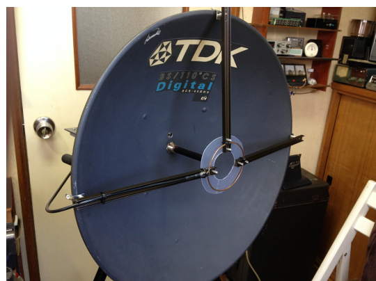
■相手局の位地確認の為の1.2MHzループアンテナ
